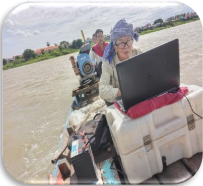
រូបភាពទី ៣៧: រូបភាពសកម្មភាពវាស់ធារទឹកដោយឧបករណ៍ Current Meter និង ADCP
