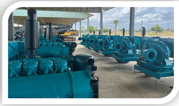
រូបភាពទី ២០: ម៉ាស៊ីនបូមទឹកចល័ត កម្លាំង ៦៥សេះ ក្រោយការងារថែទាំ និងជួសជុលរួចរាល់នៅជម្រកគ្រឿងចក្រ និងម៉ាស៊ីនបូមទឹក
