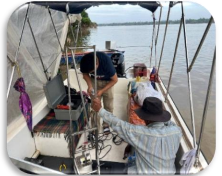
រូបភាពទី ៣៧: រូបភាពសកម្មភាពវាស់ធារទឹកដោយឧបករណ៍ Current Meter និង ADCP
